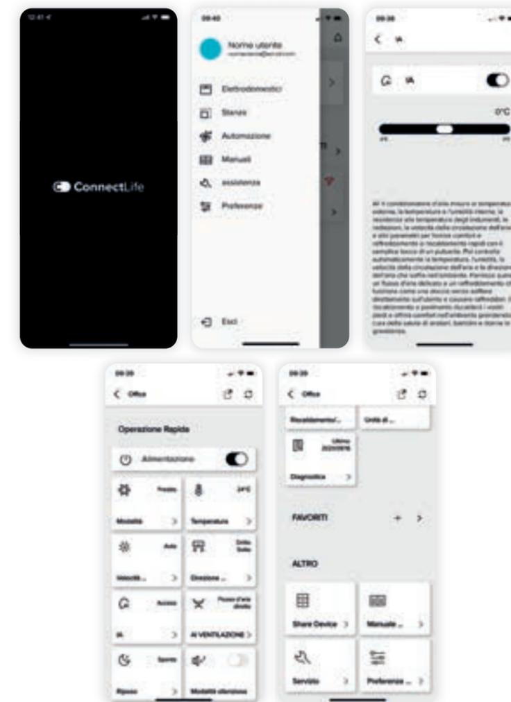
Dopo aver scaricato la app e associato il climatizzatore, la app consente di gestire modalità di funzionamento, temperatura, velocità di ventilazione e flusso dell'aria. Dalla sezione «Automazione» è inoltre possibile impostare i timer giornalieri o settimanali.
